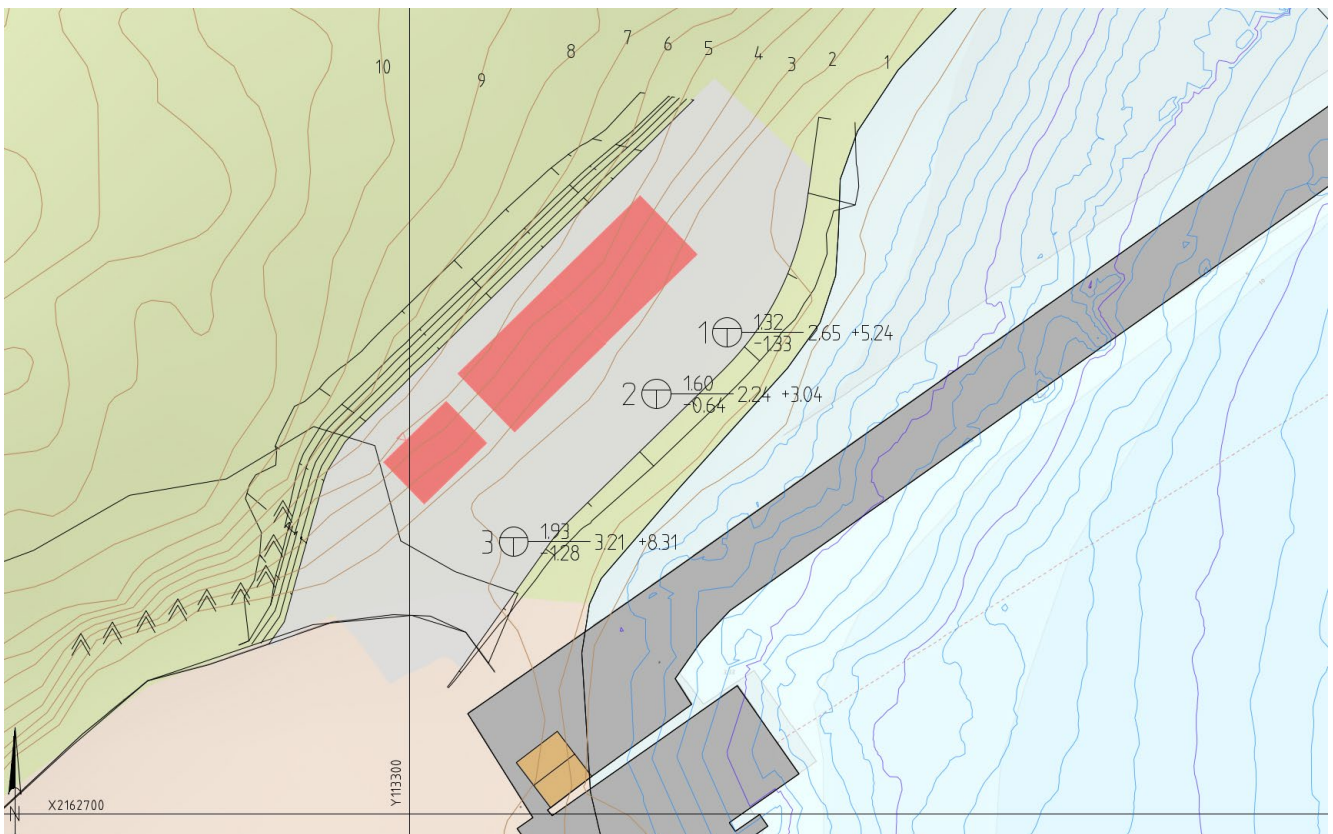
Figur 3-1: Utførte grunnboringer og løsmassetykkelse. Utklipp fra borplan. Skjæringsgeometri for planlagt skjæring på utsnittet er ikke gjeldende.
