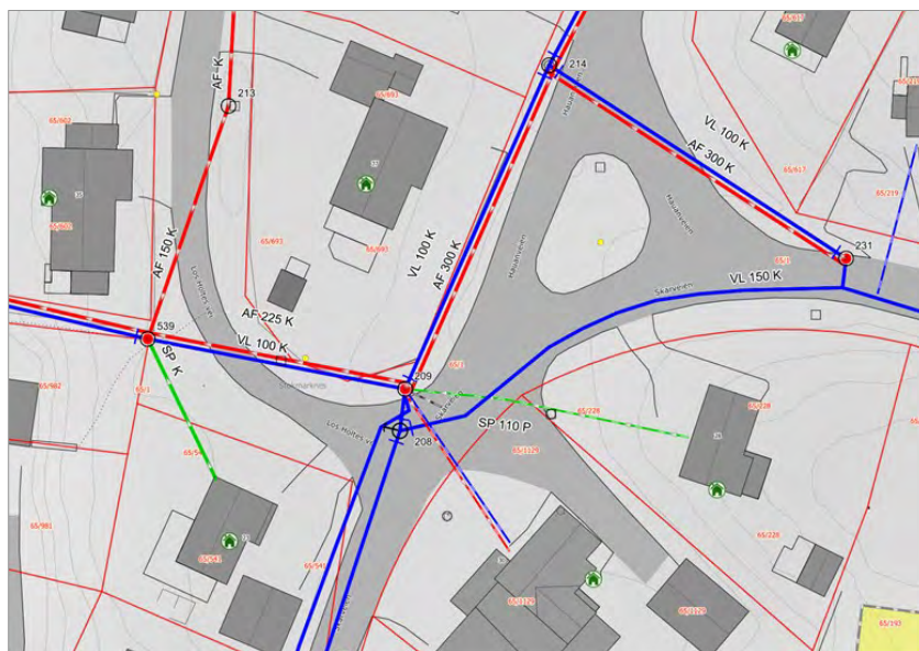
FIGUR 15. TRASE FOR EKSISTERENDE VA-LEDNINGER
