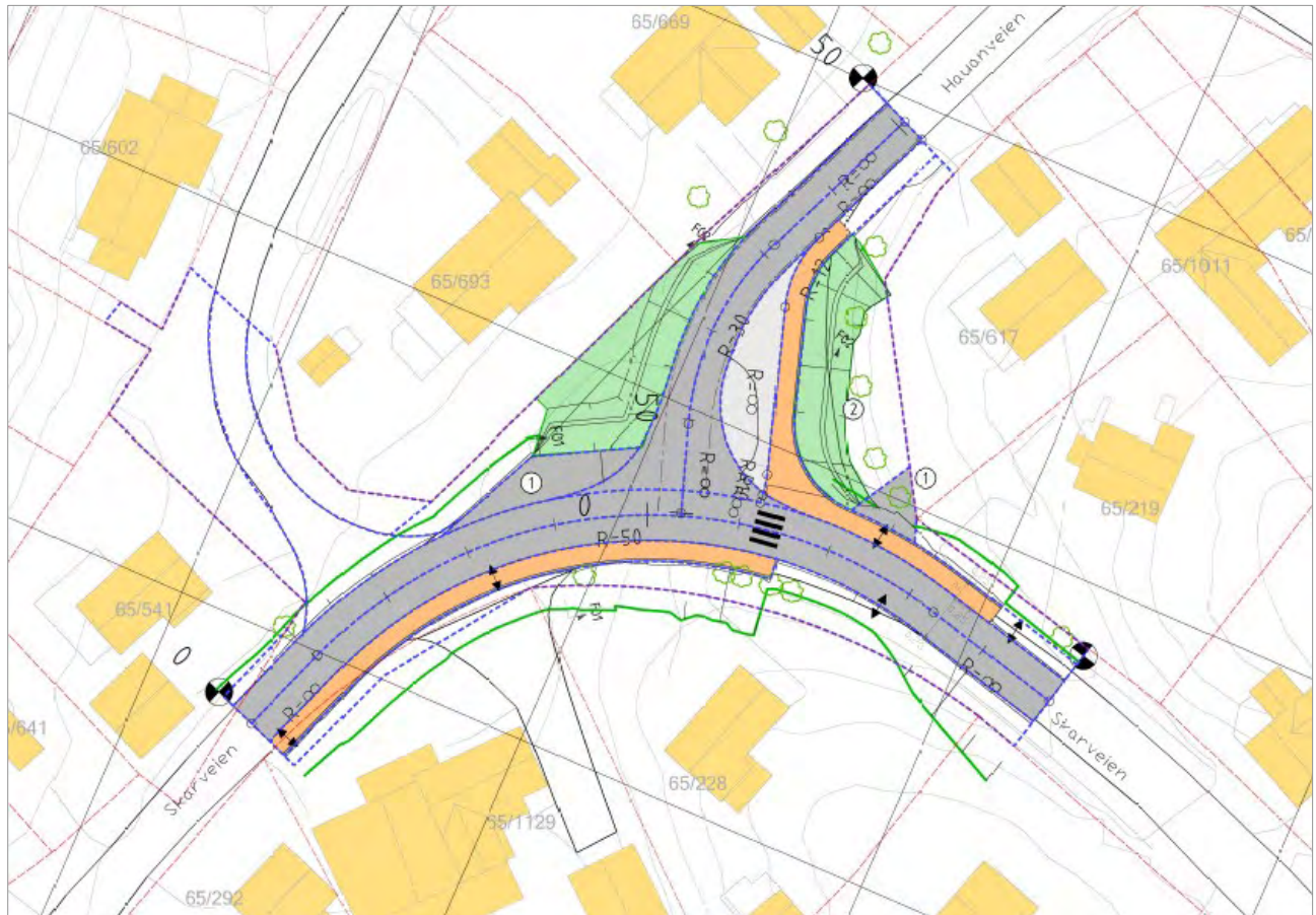
FIGUR 18. UTMUSPLAN VISER PROSJEKERT VEI OG FORTAU SAMT REGULERINGSLINJER (BLÅTT) OG PLANAVGRENSNING (LILLA).
